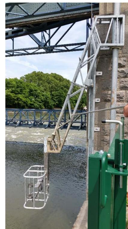
Panier de capteurs soutenu par un bras électrique
