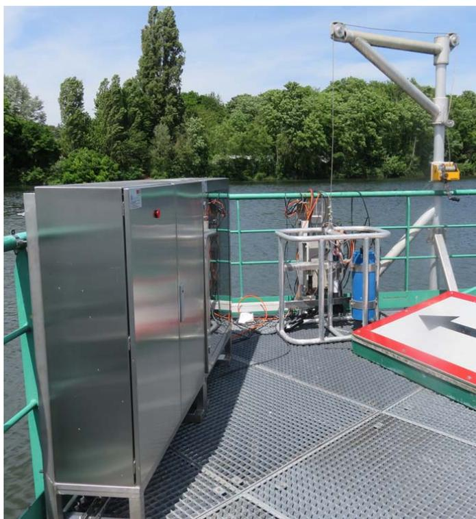
Panier de capteurs soutenu par un bras manuel
