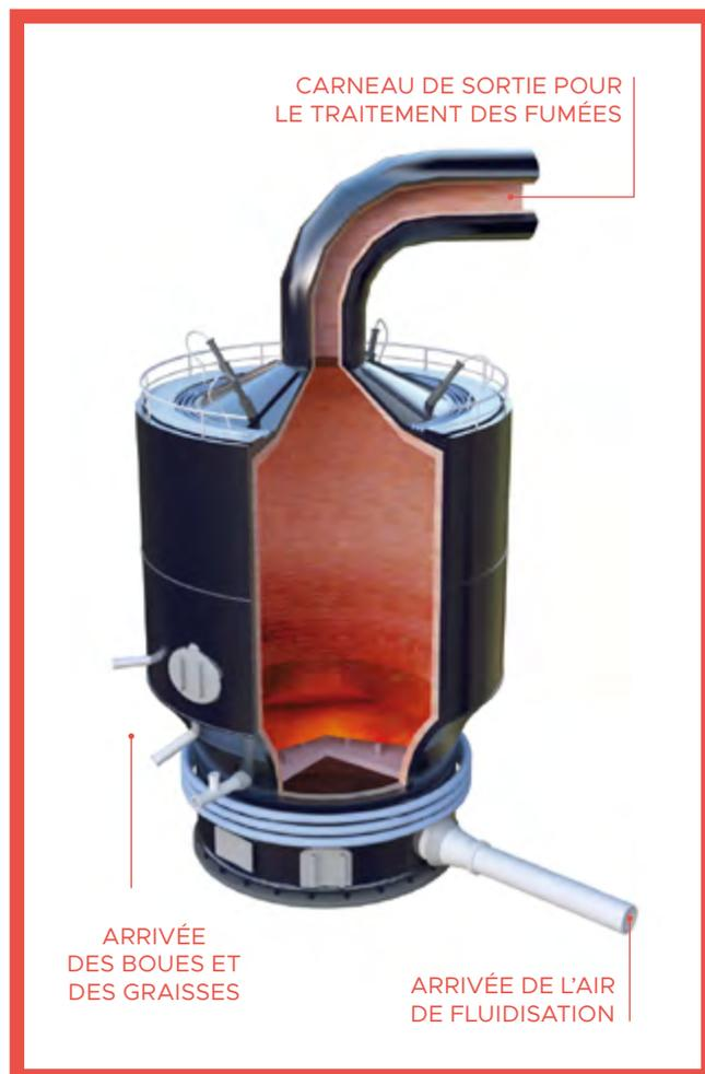
Schéma d'un four à lit de sable fluidisé.
