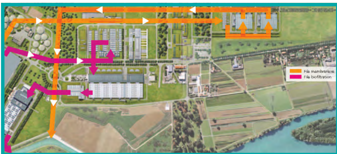
Répartition de l'eau sur les deux files de traitement biologique.
