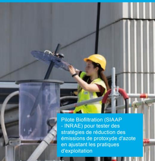
Pilote Biofiltration (SIAAP - INRAE) pour tester des stratégies de réduction des émissions de protoxyde d'azote en ajustant les pratiques d'exploitation
